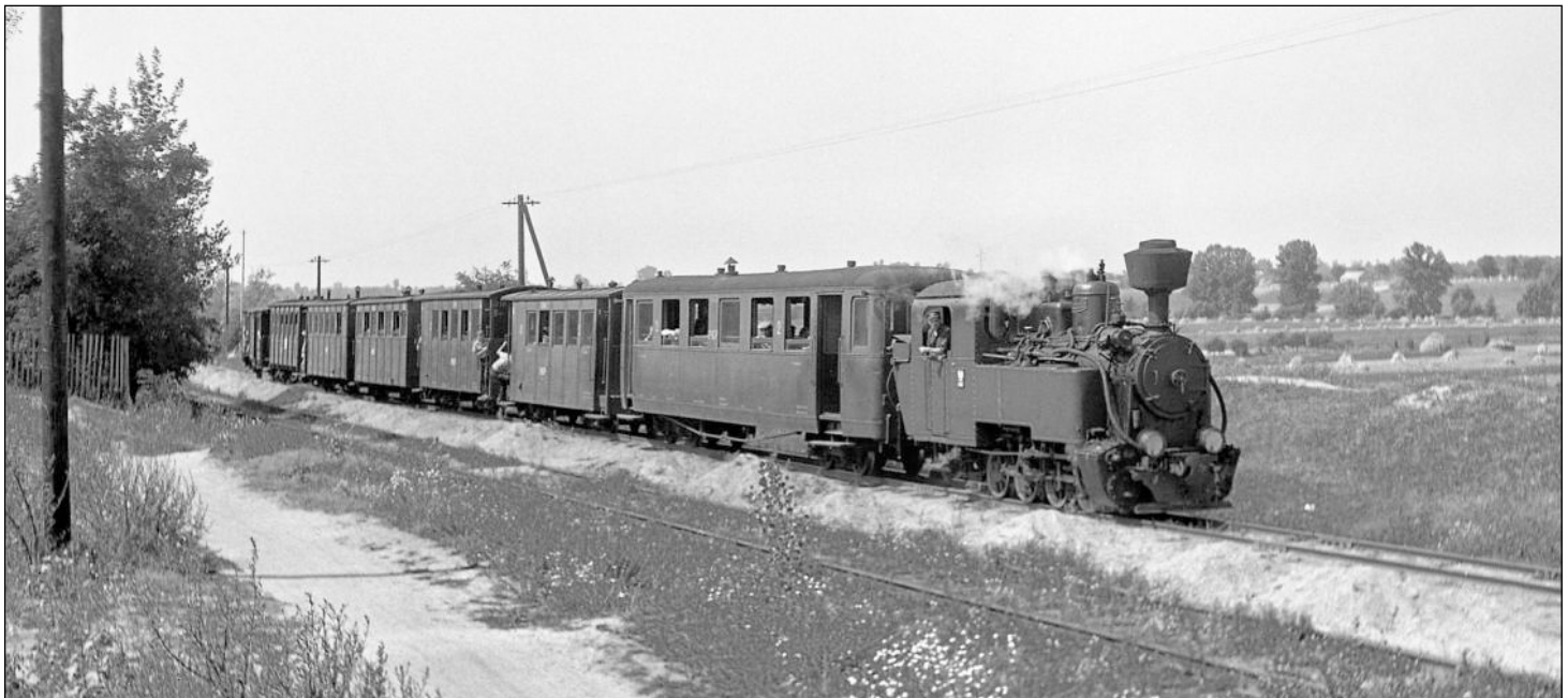
Pociąg pasażerski z Sochaczewa Wąskotorowego zbliża się do stacji w Chodakowie. Skład prowadzi parowóz typu „Kujawy” zbudowany przez WSABP, w 1928 r. z nr fabr. 88 na zamówienie Ministerstwa Spraw Wojskowych, 18 lipca 1964 r.
